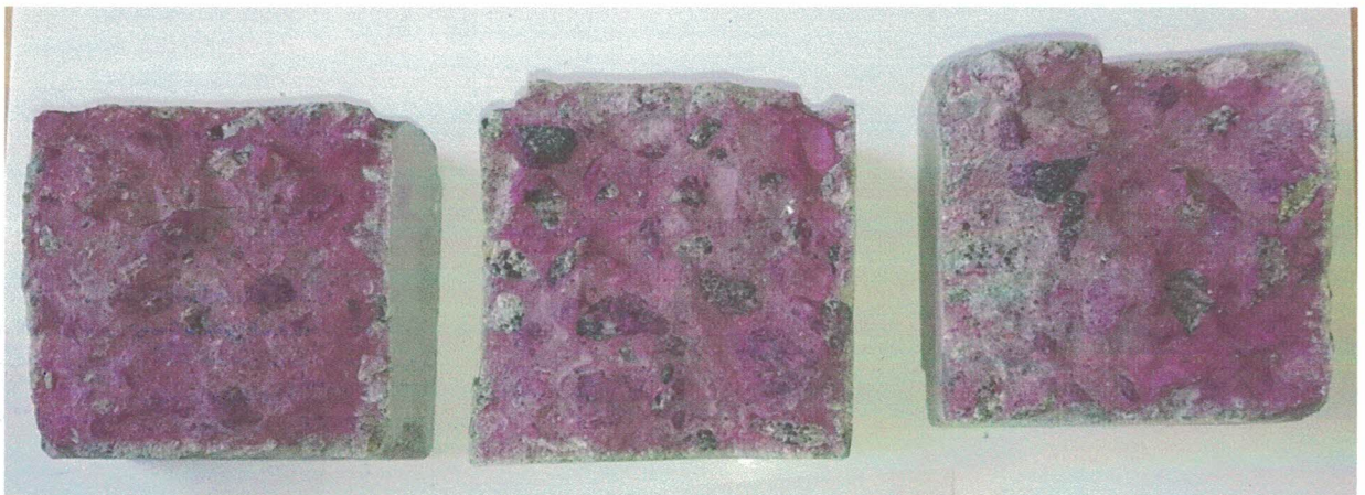
Рис. 6. Внешний вид бетонных образцов с добавкой в бетон «Пенетрон-Адмикс» после 7 суток испытаний.
