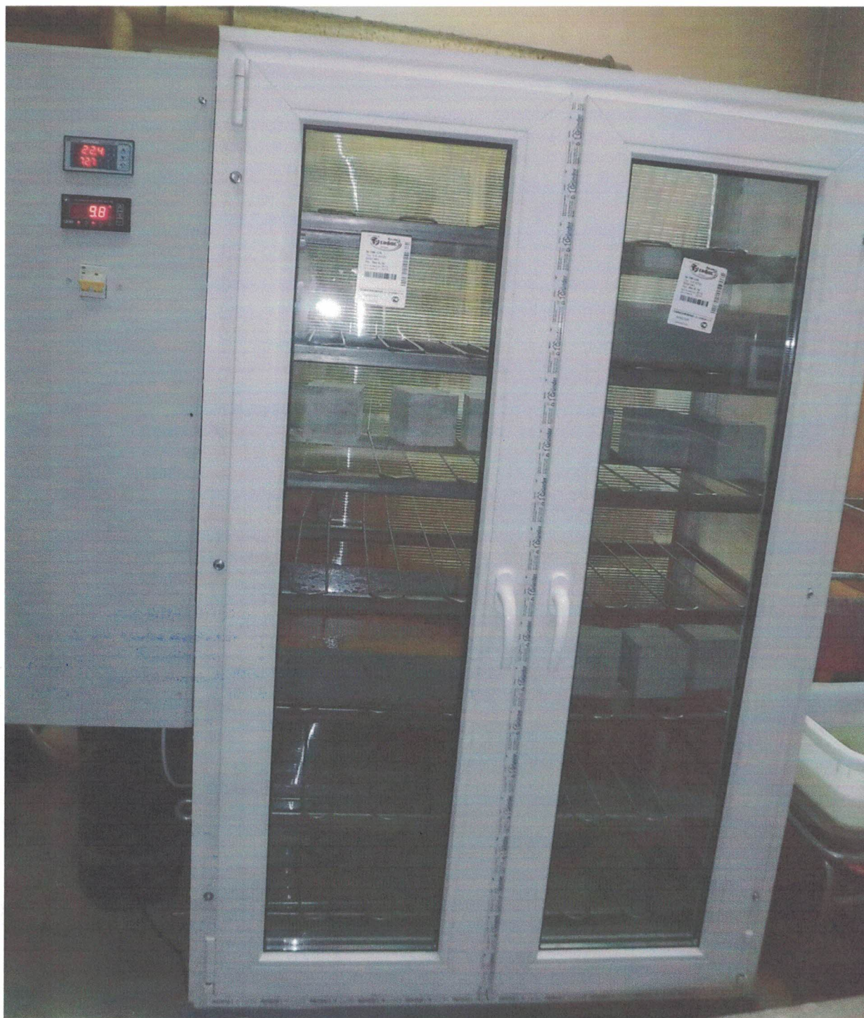
Рис. 4. Общий вид камеры для определения диффузионной проницаемости бетона для углекислого газа.
