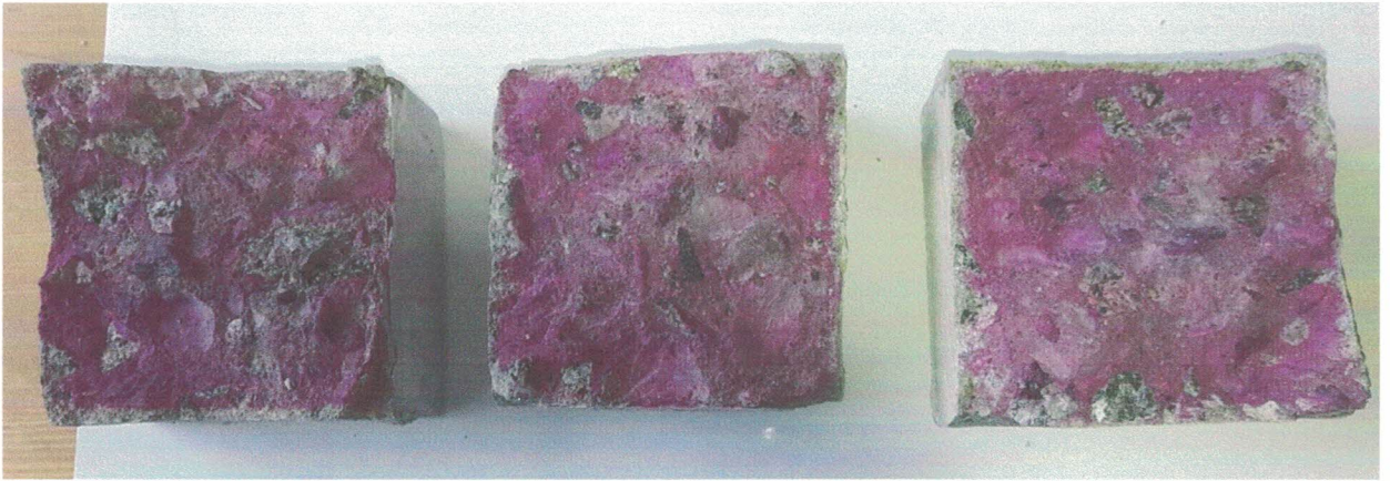
Рис. 5. Внешний вид бетонных образцов с нанесенным материалом «Пенетрон» после 7 суток испытаний.
