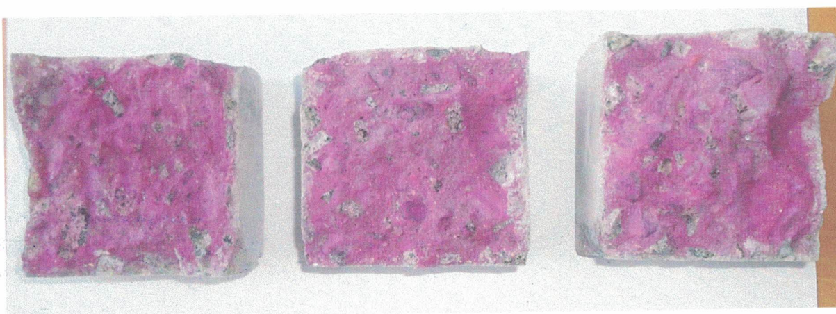
Рис. 9. Внешний вид бетонных образцов с добавкой в бетон «Пенетрон-Адмикс» после 14 суток испытаний.
