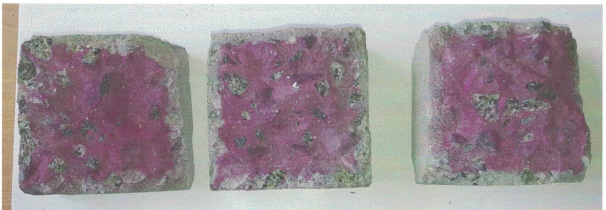
Рис. 7. Внешний вид контрольных бетонных образцов после 7 суток испытаний.
